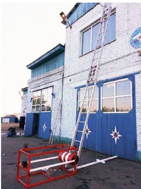
Испытание трехколенной лестницы (рис.1)
