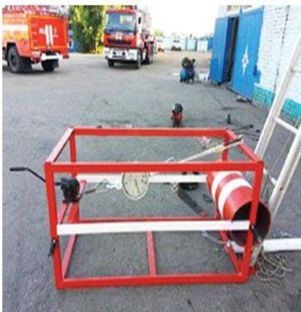
Испытание рукавной задержки (рис.3)
