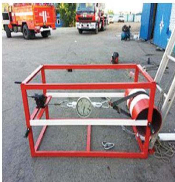
Испытание спасательного пояса и карабина (рис.4)
